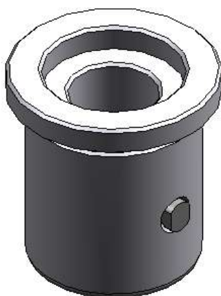
Riduzione da stazione B a stazione A per punzoni Cod. 600/5P
